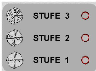
Auf der Kontrolltafel kann man die Geschwindigkeit der Funktionstätigkeit des Gerätes entnehmen, angezeigt durch das Aufleuchten des entsprechenden gelben Leds: Stufe 1, Stufe 2 und Stufe 3.
