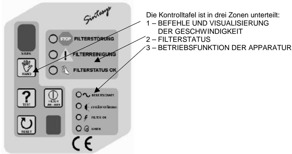
Die Einrichtungen, die den manuellen Eingriff und eine ersichtliche Kontrolle der Funktionsbedingungen ermöglichen, sind nachfolgend wiedergegeben.
